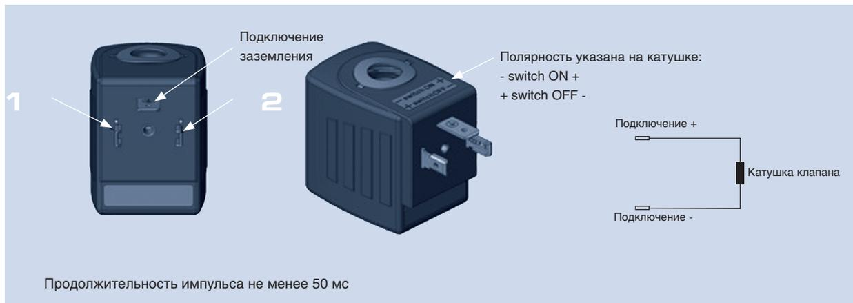
**Внимание:** используйте только разъемы без электропроводки для импульсного исполнения!
